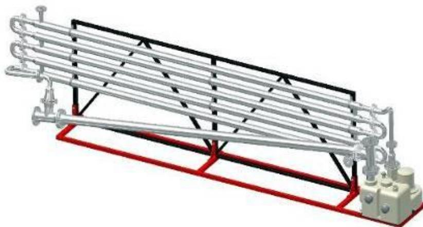
Рисунок 5 – Общий вид варианта моноблочной компоновки утилизатора с побудителем циркуляции и выпуском-байпасом
